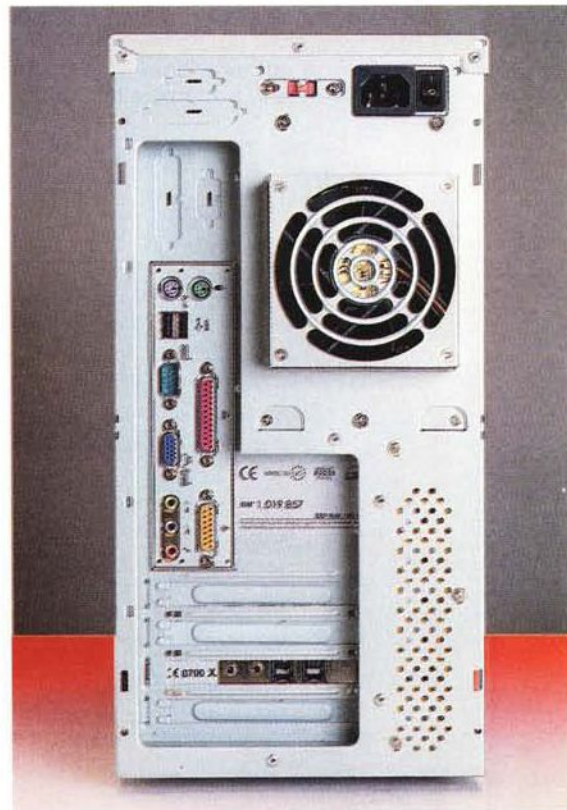
Il retro della macchina: si noti la posizione inusuale ed aggettante della ventola di raffreddamento dell'alimentatore, la relativa posizione delle prese di alimentazione e i connettori di comunicazione della scheda madre, questi ultimi colorati per renderne più semplice l'individuazione.
